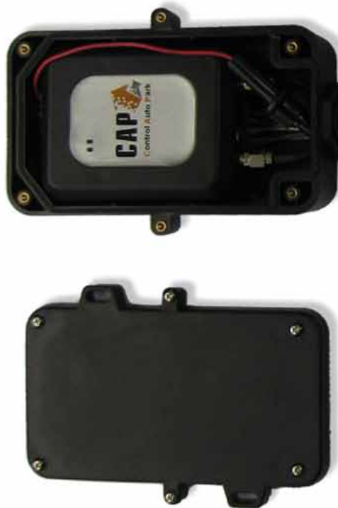
Автомобильный трекер CAP VT-10 в защитном корпусе (IP67)
